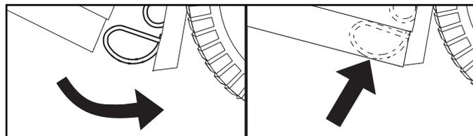
**NOTĂ:** Dacă se reglează înălțimea ansamblului sacului, poate fi necesar să se regleze înălțimea arcului sacului, pentru a menține ansamblul sacului bine închis. Pentru a o regla, slăbiți piulița (4) suficient încât să permiteți închizătorii cu arc a sacului să se deplaseze. Faceți să alunecă închizătoarea cu arc pentru sac în sus sau în jos, după necesități, având grijă ca ansamblul sacului să fie închis foarte bine. Strângeți din nou piulița foarte bine.
