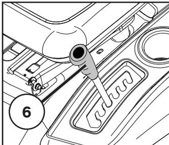
**RU 6. Быстрый подъем/опускание режущего блока**
