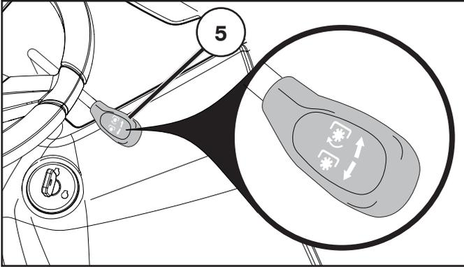
**RU 5. Подключение/отключение режущего блока.**
